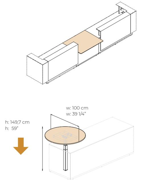
**piano conversazione con colonna elettrica**, conversation top with height-adjustable column, plan conversation latéral avec colonne électrique, platte für Gesprächstisch mit elektrische Säule, conferentiebladen met elektrische kolom, plano de conversación con columna eléctrica
